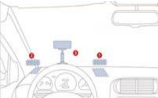
La cámara DMS puede instalarse en el salpicadero con **cinta adhesiva** o con **4 tornillos**.
