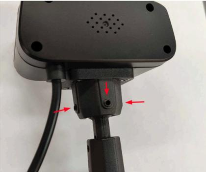
La **altura** puede ajustarse aflojando 3 tornillos situados en la parte superior de la placa de montaje de la cámara.
